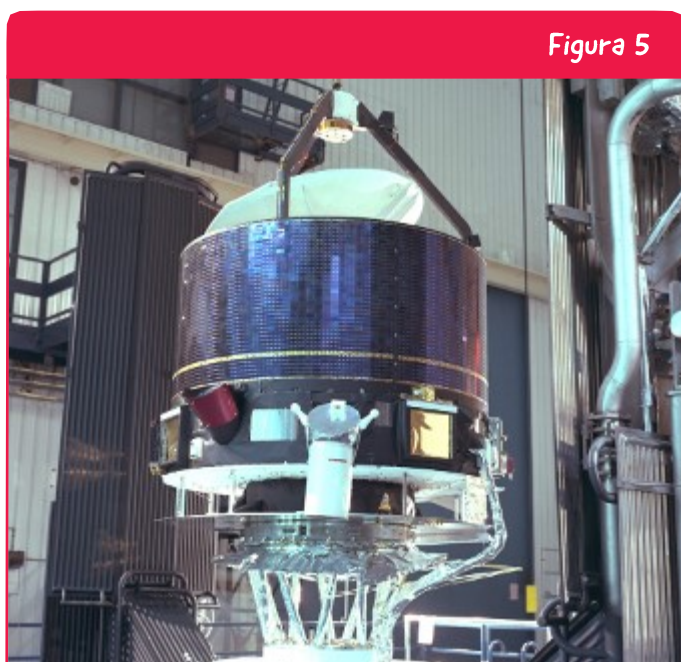
↑ Giotto pronto per il test di simulazione solare.
